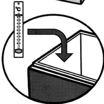
保冷容器（クーラーボックス等）は、開閉部がしっかりと閉まる構造で密閉性があり、素材には断熱材を用いる
