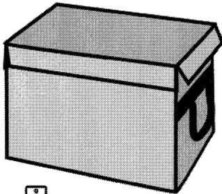
容器表面は遮光シート（アルミ断熱遮光シート等）で遮光性を持たせる
